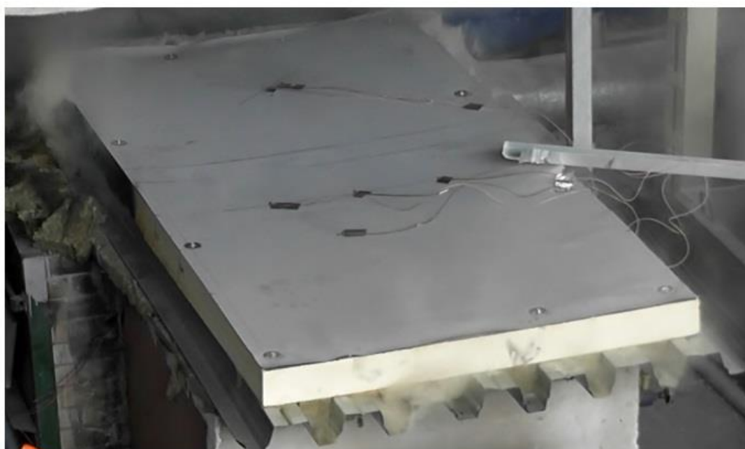
Рисунок 8. Образцы ПИР из группы горючести Г4 и типичные результаты испытаний на горючесть по методу II ГОСТ 30244-94: а – образцы до испытания, б – после испытания, в – изменение средней по четырём термодатчикам температуры дымовых газов во время испытания (рис. авт.)
