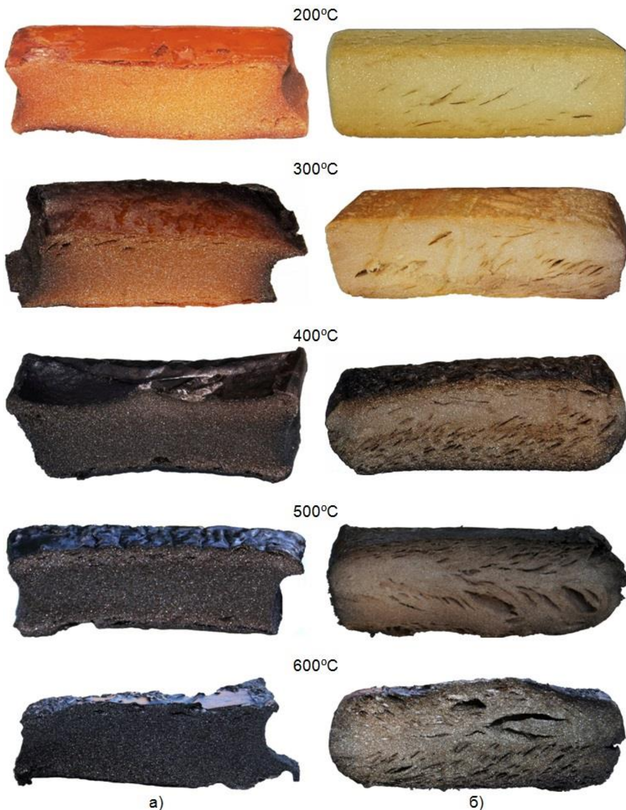
Рисунок 41. Сравнение образцов после «Тепловых тестов» при температурах: 200, 300, ..., 600 °С, время экспозиции - 60 мин: а – образцы без расслоений (ПИР2), б – при образовании пор в виде щелей (ПИР10) (рис. авт.)
