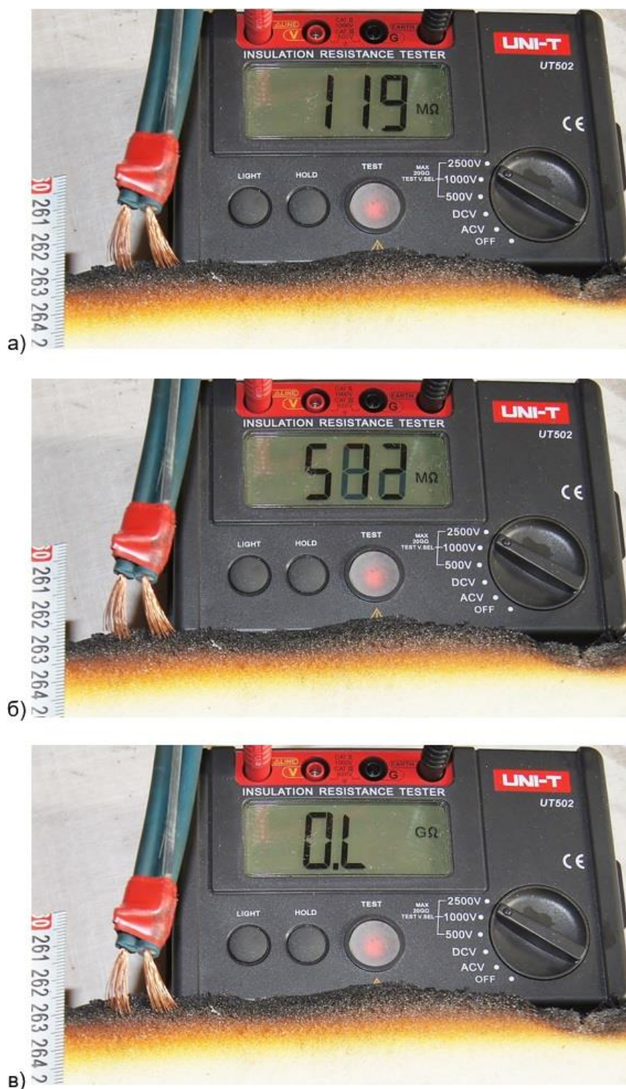
Рисунок 37. Повреждения при испытании на горючесть образца ПИР «Арианит» без обкладок (горючесть – Г1, плотность – 47...50 кг/м 3 , тип повреждения – ПИР2) и электрические сопротивления по толщине повреждённого слоя: а – 119 МОм на глубине 1 мм, б – 582 Мом на глубине 2 мм, в – более 20 ГОм на глубине 3 мм и более (рис. авт.)
