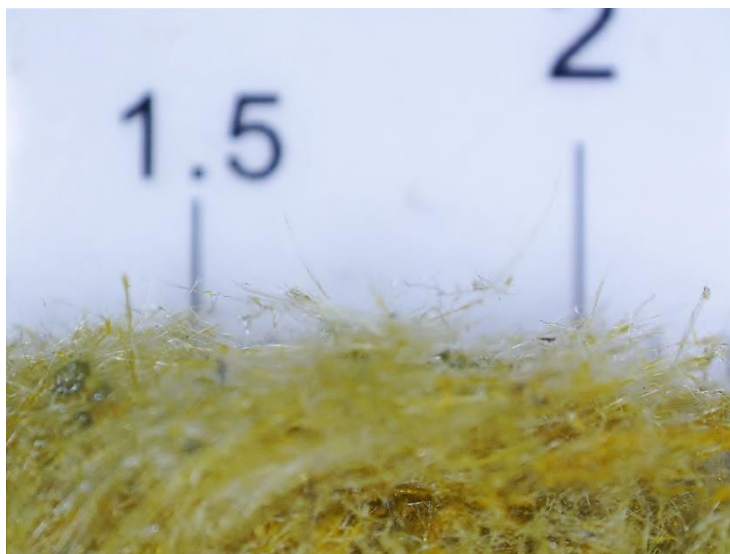
Рисунок 14. Срез неповреждённой части МВ образца под микроскопом (цифры соответствуют размеру в см). Содержание связующих веществ – 4,5% [11]
