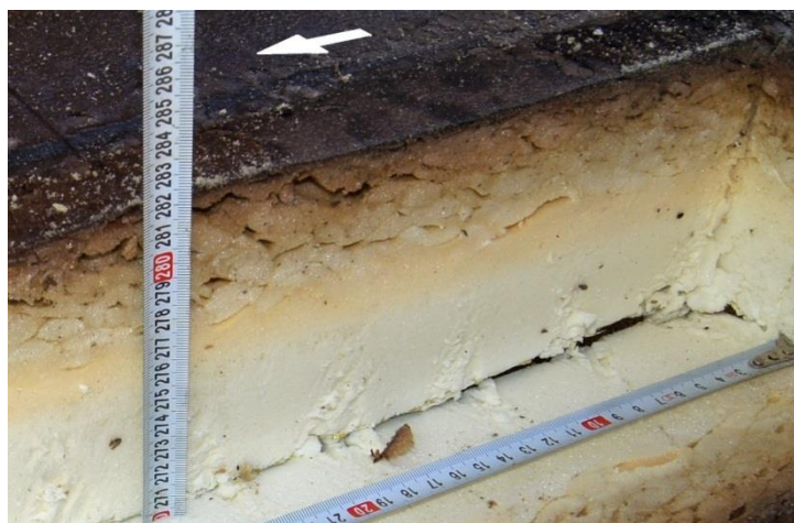
Рисунок 24. Тип повреждения ПИР3 теплоизоляционного материала у начала контрольной зоны при испытании на пожарную опасность покрытия из сэндвич-панелей по ГОСТ 30403-2012, класс пожарной опасности КЗ(15). Стальная обшивка демонтирована. Стрелкой показано направление теплового потока над поверхностью (справа налево). Раковины ориентации не имеют, на поверхности - однородная корка (рис. авт.)
