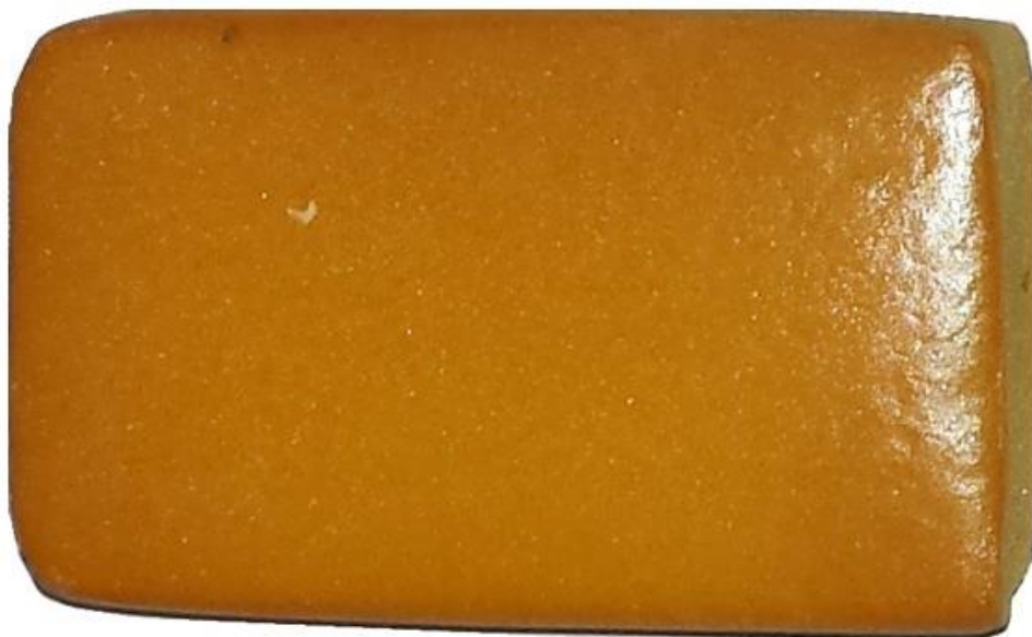
Рисунок 39. Образец газопроницаемого ПИР «Арианит» (группа горючести Г1): а, б – разрез до и после «Теста 200», в – поверхность образца после «Теста 200» (рис. авт.)
