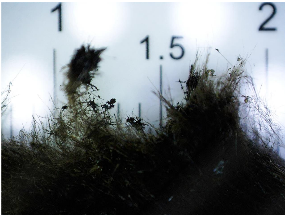
Рисунок 16. Срез повреждённого MB образца под микроскопом (цифры соответствуют размеру в см, тип повреждений – MB2) [11]
