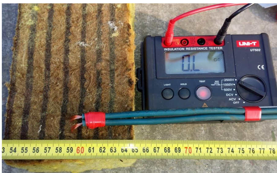
Рисунок 1. Неповреждённый образец МВ (ламель с праймером, который нанесён продольными параллельными полосами) во время измерения электрического сопротивления на поверхности: R > 20 ГОм (рис. авт.)
