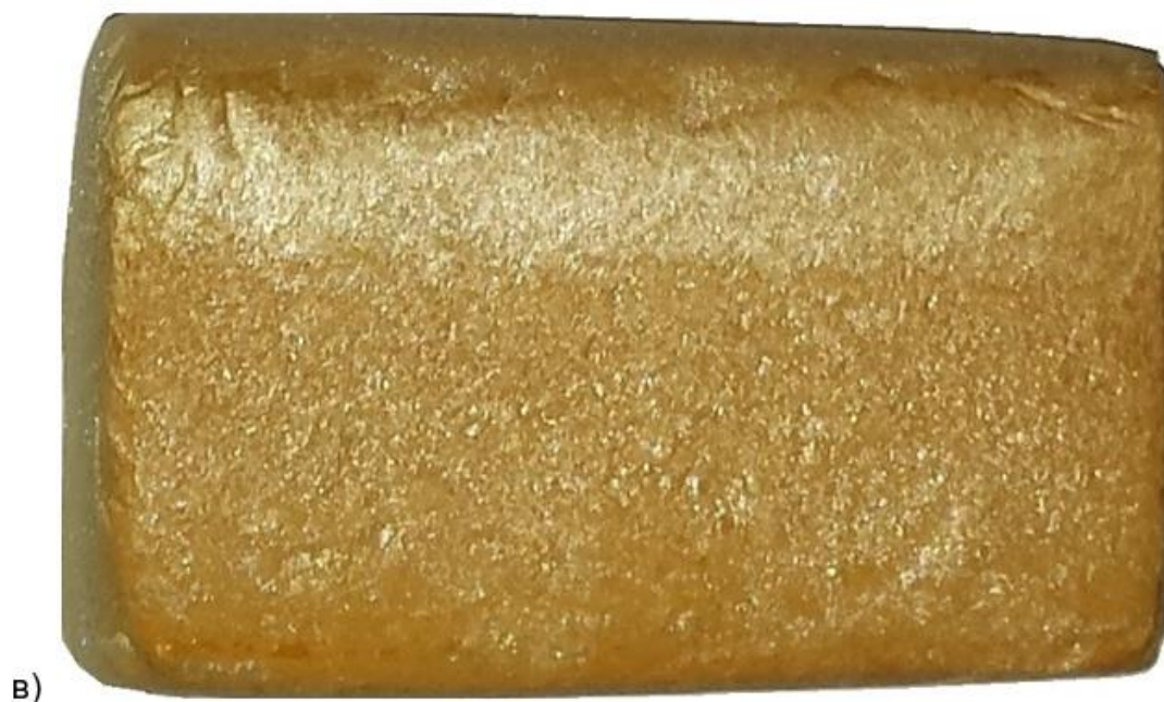
Рисунок 40. Образец непроницаемого для газа ПИР (группа горючести Г2): а, б – разрез до и после «Теста 200», в – поверхность образца после «Теста 200» (рис. авт.)
