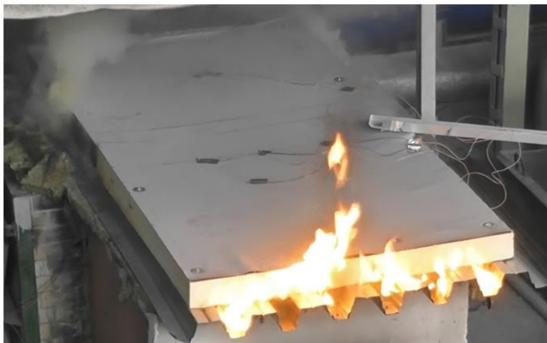
Рисунок 9. Типичное выделение газов при термическом разложении пенополимерных материалов при огневом испытании строительных конструкций: а – выделение газов при испытании покрытия на пожарную опасность по ГОСТ 30403-2012, б – воспламенение газов на необогреваемой поверхности посредством факела на 10-й минуте испытания и горение газов продолжительностью более 5 сек, строительная конструкция относится к классу пожарной опасности КЗ(15) (рис. авт.)
