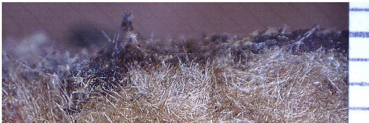
Рисунок 15. Срез частично повреждённого MB образца у поверхности под микроскопом (деления шкалы справа выполнены через 1 мм, тип повреждений – MB2) [11]
