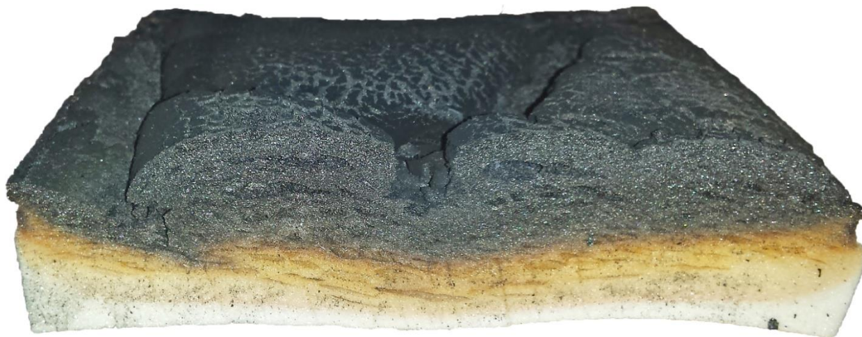
Рисунок 30. Повреждение типа ПИР8 в поперечном разрезе образца при испытании на горючесть по методу II ГОСТ 30244-94 (группа горючести – Г3). Образование на поверхности крупных агломератов (волн) без трещин, обугливание и вспучивание по объёму в форме щелей (рис. авт.)
