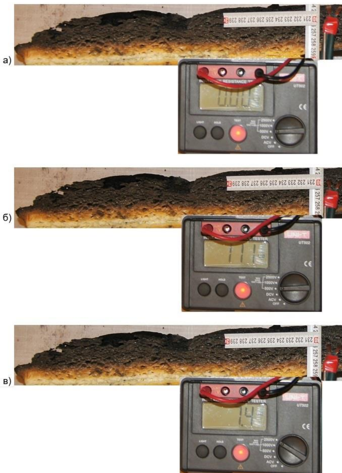
Рисунок 38. Повреждения при испытании на горючесть образца ПИР (группа горючести – ГЗ, плотность – 33...35 кг/м 3 , тип повреждения – ПИР8) и электрические сопротивления по толщине повреждённого слоя: а – 0 МОм на глубине 1 мм, б – 111 Мом на глубине 12 мм, в – 7,4 ГОм на глубине 19 мм (рис. авт.)
