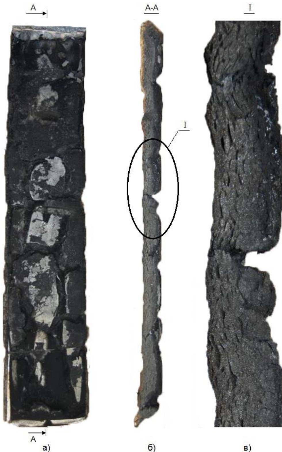
Рисунок 35. Тип повреждения ПИР10 при испытании на горючесть по методу II ГОСТ 30244-94 (группа горючести – Г4). Поверхность образца рассечена сквозными щелями, зафиксировано вспучивание по объёму порами в форме щелей: а – общий вид образца, б – продольный разрез, в – тоже увеличено (рис. авт.)
