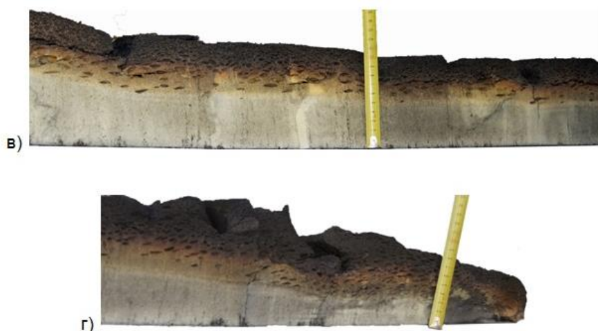
Рисунок 33. Повреждения типа ПИР8 теплоизоляционного материала (группа горючести – ГЗ) стены из сэндвич-панелей при натуральных огневых испытаниях фрагмента с локальным расположением пожарной нагрузки: а – вырез вдоль направления изменения интенсивности огневого воздействия, б, в, г – повреждения на участках минимального, среднего и максимального огневого воздействия соответственно (рис. авт.)
