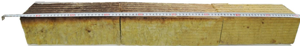
Рисунок 13. Повреждения МВ с праймером при испытании на пожарную опасность стены из сэндвич-панелей по ГОСТ Р 56076-2014. КERN теплоизоляционного материала отобран из контрольной зоны по длине образца, линейка приложена от начала контрольной зоны, время огневого воздействия – 15 мин, присвоенный класс пожарной опасности строительной конструкции – К1(15), тип повреждения – МВ2 (рис. авт.)
