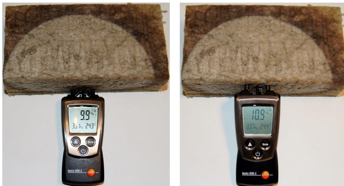
Рисунок 7. Разрез образца MB, повреждённого при стандартном испытании на воспламеняемость по ГОСТ 30402-96. Контроль прибором Testo-606-2 показывает электропроводность по всей толщине теплового воздействия (рис. авт.)
