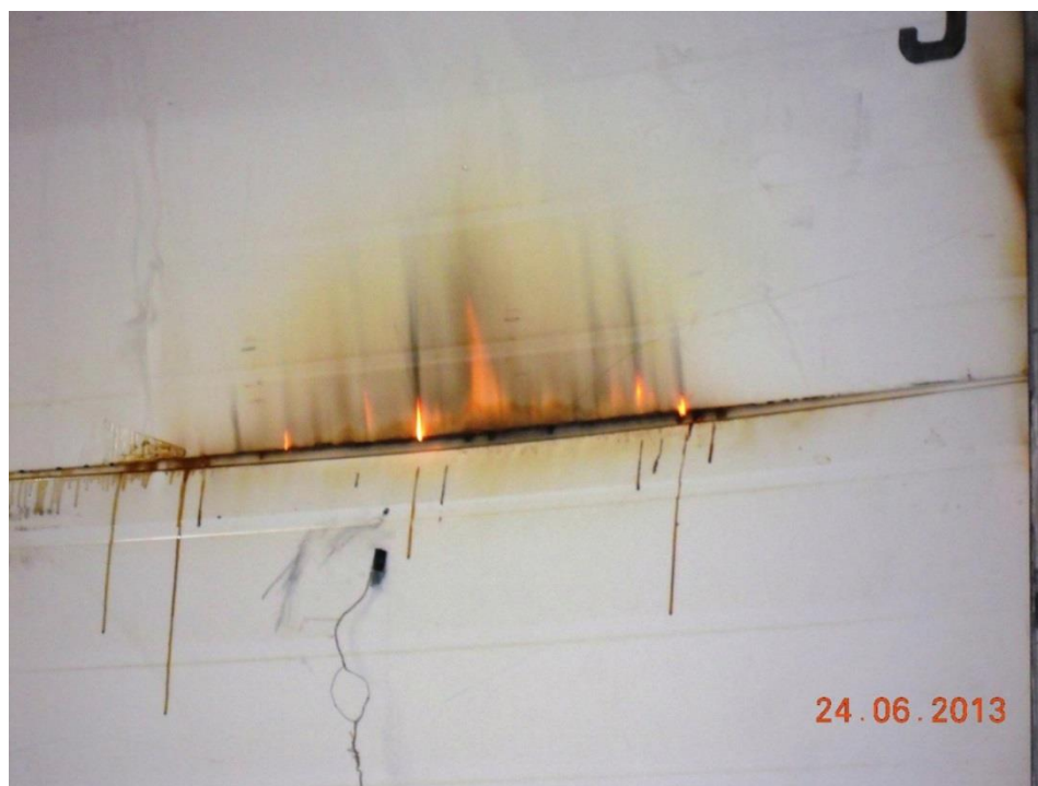
Рисунок 10. Пример горения при испытании на огнестойкость стен из сэндвич – панелей с минеральной ватой по ГОСТ 30247.1-94. Вдоль стыка панелей заметны коричневые подтёки образующихся маслянистых горючих веществ (рис. авт.)
