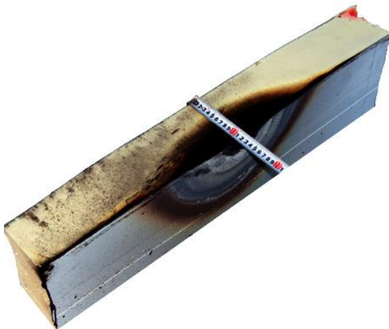
Рисунок 32. Повреждение типа ПИР8 для материала сэндвич-панели при натуральных испытаниях с точечным огненным источником. Группа горючести – ГЗ. Температура обшивки на обогреваемой стороне – 921°С, время воздействия – 15 мин (рис. авт.)
