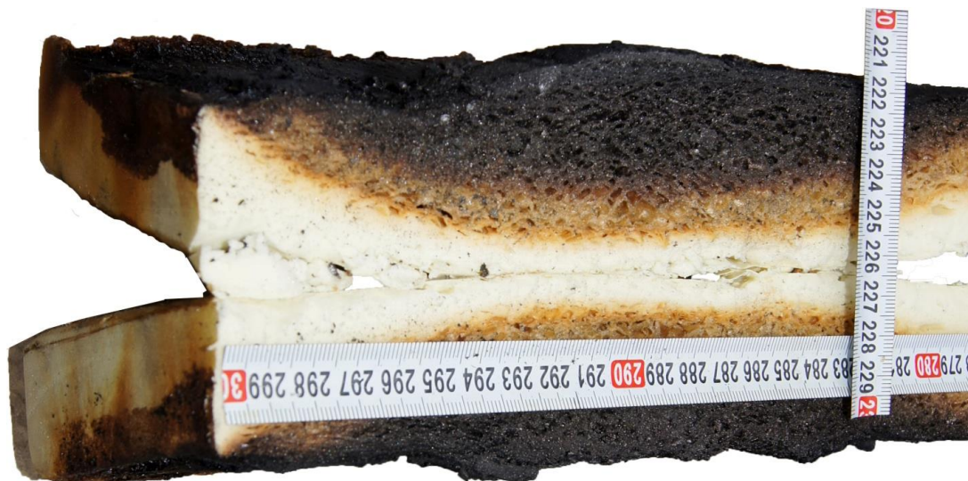
Рисунок 29. Повреждение типа ПИР7 при испытании на горючесть по методу II ГОСТ 30244-94 (группа горючести – Г2). Образование на поверхности крупных агломератов без трещин, обугливание и вспучивание по объёму в форме мелких раковин (рис. авт.)
