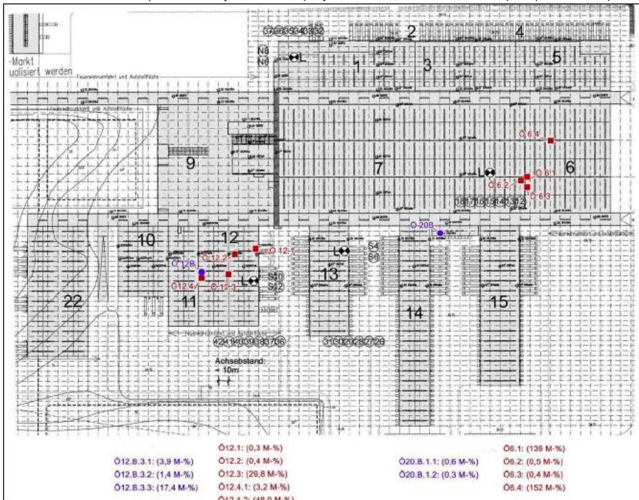
Рис. 11. План кровельного покрытия с указанием мест протечек и данными по содержанию влаги в изоляционном материале.
