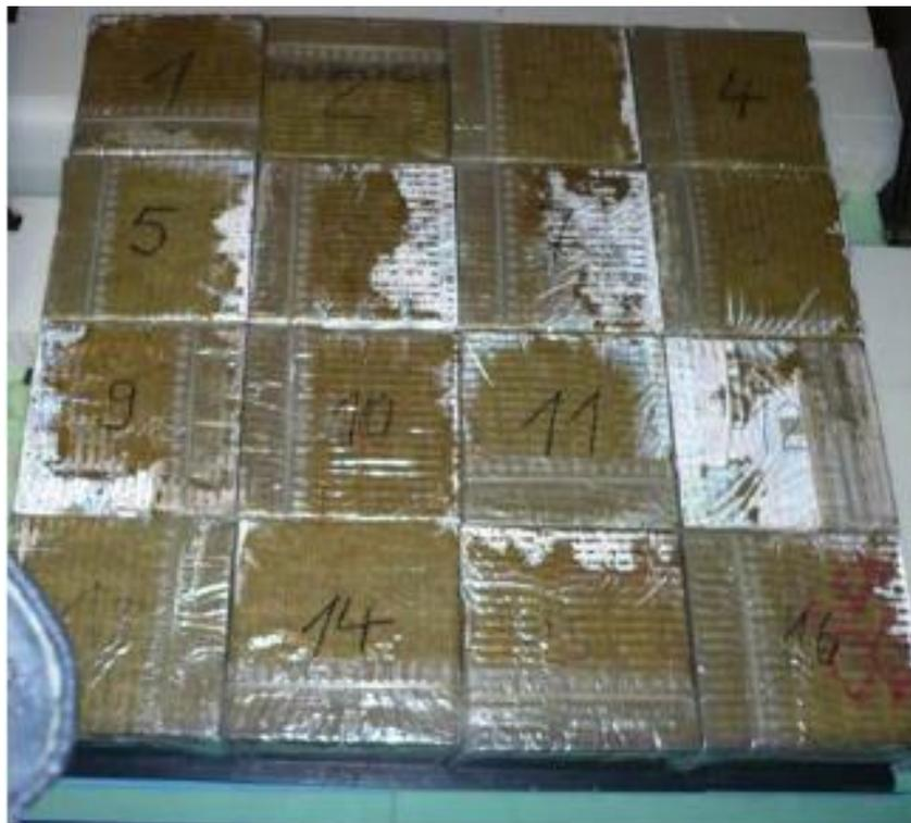
Рис. 5: Расположение образцов изоляционного материала на нижнем термостате
