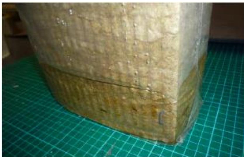
**Рис. 4:** Минераловатный материал с заданным содержанием влаги закреплен под пластмассовой пленкой
