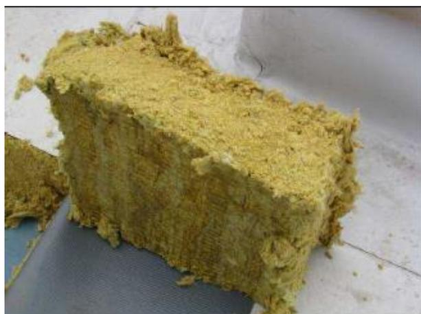
Рис. 24. Образец 5 со сниженной прочностью (устойчивостью к нагрузкам)
