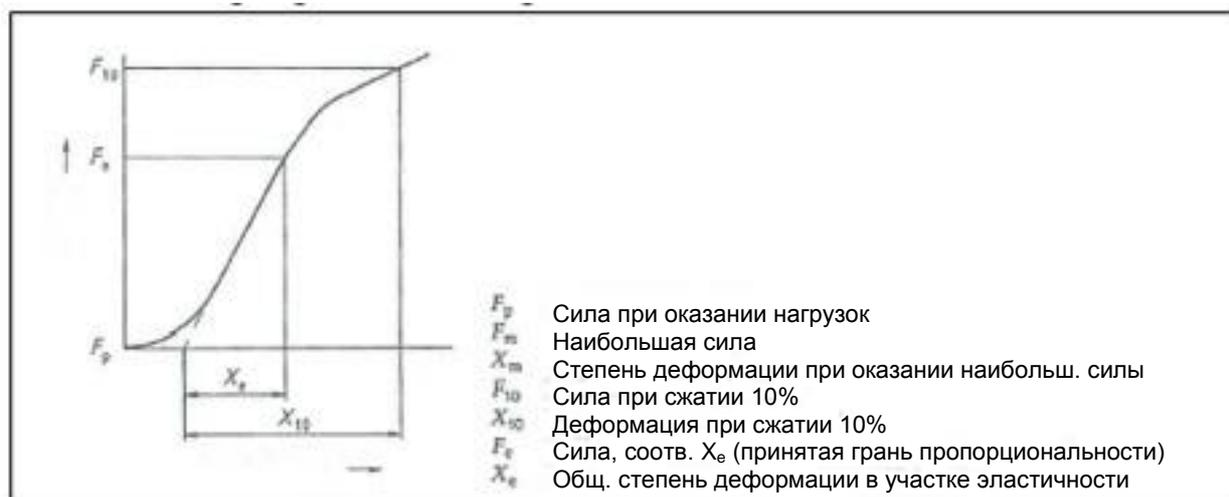
Рис. 33. Пример графика сила-деформация; фрагмент Рис. 1 стандарта DIN EN 826: 1996-05
