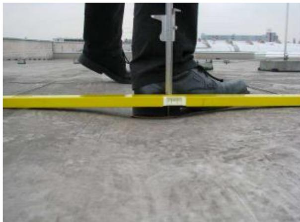
Рис. 6 и 7. На самых мягких участках был сделан замер степени деформации посредством твердой волокнистой плиты и алюминиевой трубы (водяной уровень). На фото справа – участок с самой значительной деформацией (прим. 33 мм)
