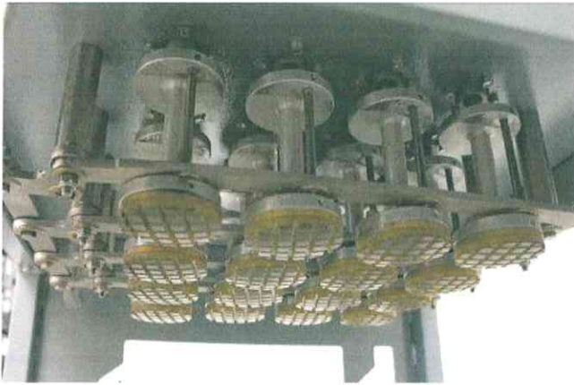
Рисунок 1 Общий вид стенда Marathon Man батареи цилиндров с наклеенной подошвой обуви и толкателей стенда
