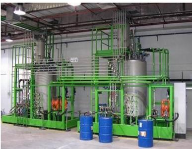
**Станции смешивания для полиэфиров и различных добавок (формулирование компонента А)**
